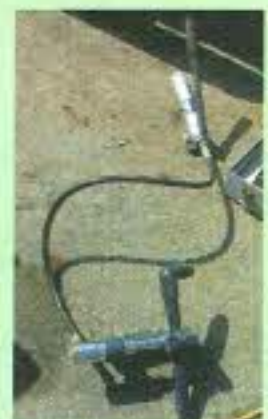
パイプ断水機(圧着機) バルブが付いていないときなど油圧でパイプを圧着するための機械
