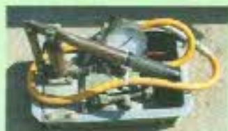
テストポンプ 水圧をかける機械です
