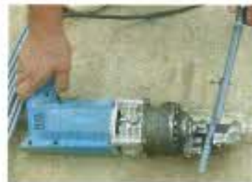
鉄筋カッター・・・鉄筋を切ります。
